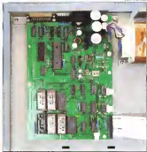
Il plotter aperto: sotto la piastra della costruzione il "plot" con la meccanica di stampa e la scheda contenuta con l'elettronica
